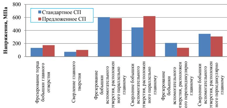
Рис. 6. Диаграмма напряжений, которые возникают в системе «СП – заготовка» при обработке поверхностей рычага
