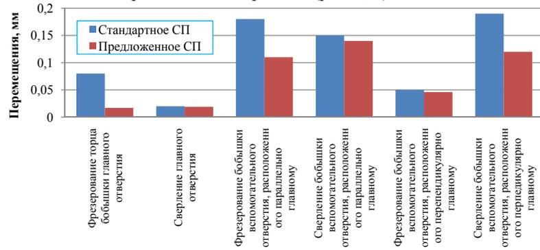
Рис. 5. Диаграмма перемещений элементов системы «СП – заготовка», которые возникают на при обработке поверхностей рычага
