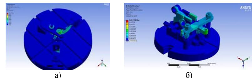
Рис. 1. Картинки перемещений, возникающие при фрезеровании торца бобышки главного отверстия: а – стандартное СП; б – предложенное СП
