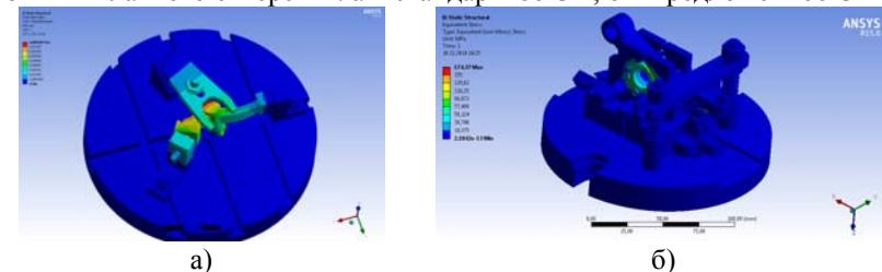
Рис. 2. Картинки напряжений, возникающие при фрезеровании торца бобышки главного отверстия: а – стандартное СП; б – предложенное СП
